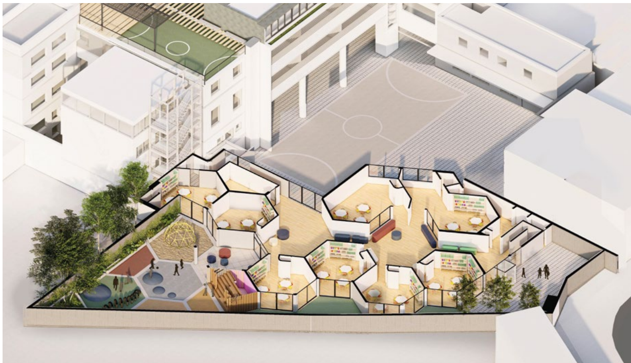
Figura 14. Planta baja: creación de un área exterior techada, reforma de los espacios existentes, generación de un anfiteatro y diseño de nuevo equipamiento para el patio.
